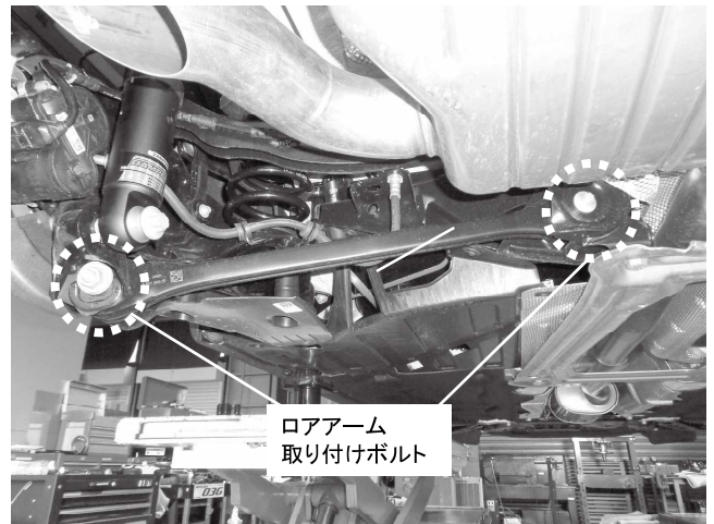
ロアアーム取り付けボルト・ナット 2カ所締め付け 締め付けトルク: 100\text{N}\cdot\text{m} ( 10.2\text{kgf}\cdot\text{m} ) ※キット取り付け時、一度緩めて1G状態で再度締め直しを実施してください
