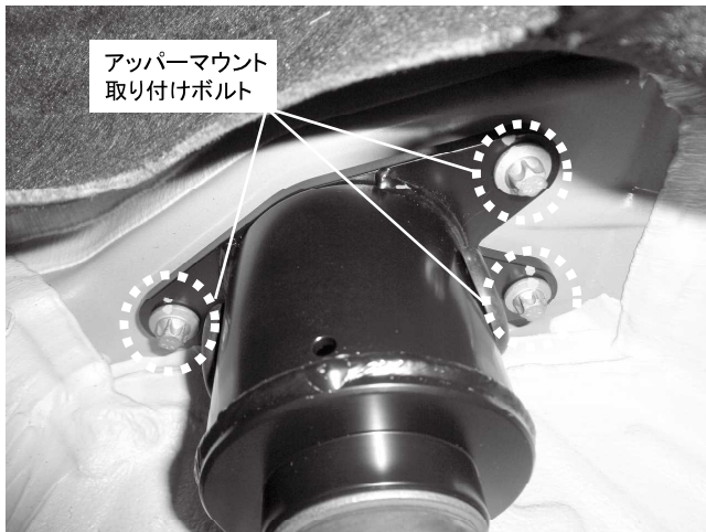
アッパーマウント取り付けボルト 3カ所締め付け 締め付けトルク: 28\text{N}\cdot\text{m} ( 2.8\text{kgf}\cdot\text{m} ) ※減衰調整ダイヤルは構造上アッパーマウント内部にあります ※アッパープレートは必ず取り付けください
