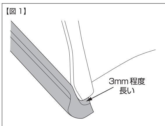
③F/Lを仮付けし、取付位置を確認したのち、取付位置をバンパーにマスキングテープ等を利用して、マーキングして下さい。この際取付け位置は図1を参照に、F/L後端部からバンパーエンドまでが493mm(±2)になるようにして下さい。また、F/L後端部は純正バンパーから後方に3mm(±2)程度伸びている設定となります。【図1参照】
