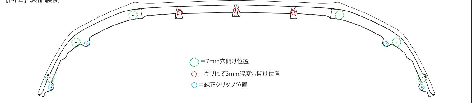
④取付用の穴位置を、バンパーにマーキングしてドリルとキリにて穴開けします。初めに、F/Lを取付位置にしっかりと合わせ、穴位置をバンパーにマーキングしたら一度F/Lを取り外して、バンパーに穴開けを行います。図2を参照にM4タッピングビス位置(3箇所)はキリで穴開けし、ボルト取付位置(6箇所)はドリルにて7mmにて穴開けを行います。【図2参照】
