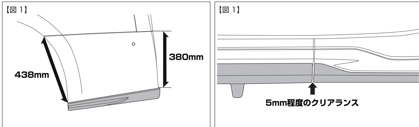
②R/Uを仮付けし、取付位置を確認したのち、取付位置をバンパーにマスキングテープ等を利用してマークイングして下さい。この際取付け位置は図1を参照に、R/U前端部からバンパーエンドまでが438mm(±2)、R/U後端部からバンパーエンドまでが380mm(±2)になるようにして下さい。また、R/Uの分割部分は5mm(±2)程度のクリアランスが出来ます。【図1参考】
