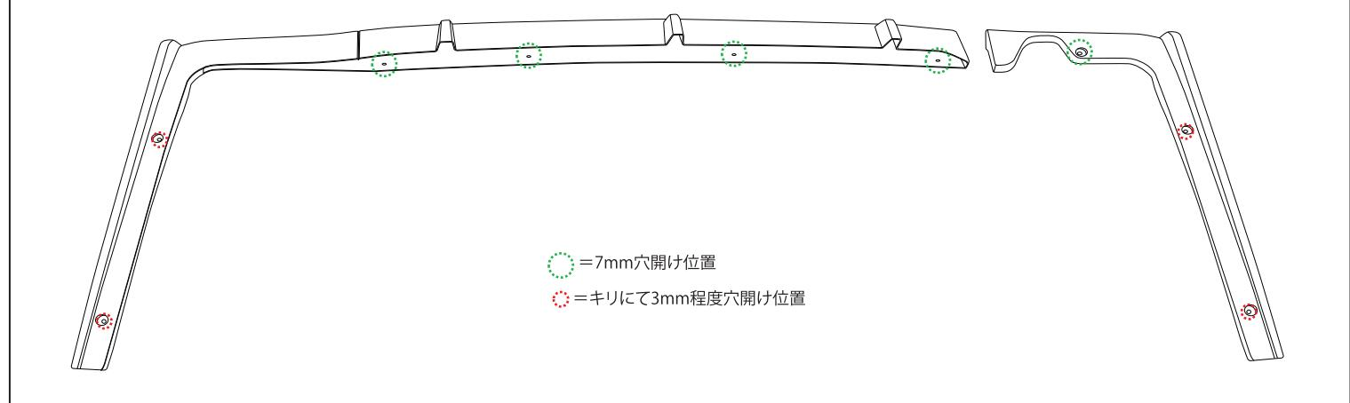
③取付用の穴位置を、バンパーにマークイングしてドリルとキリにて穴開けします。初めに、R/Uを取付位置にしっかりと合わせ、穴位置をバンパーにマークイングしたら一度R/Uを取り外して、バンパーに穴開けを行います。図2を参照にM4タッピングビス位置（4箇所）はキリで穴開けし、ボルト取付位置（5箇所）はドリルにて7mmにて穴開けを行います。【図2参考】
