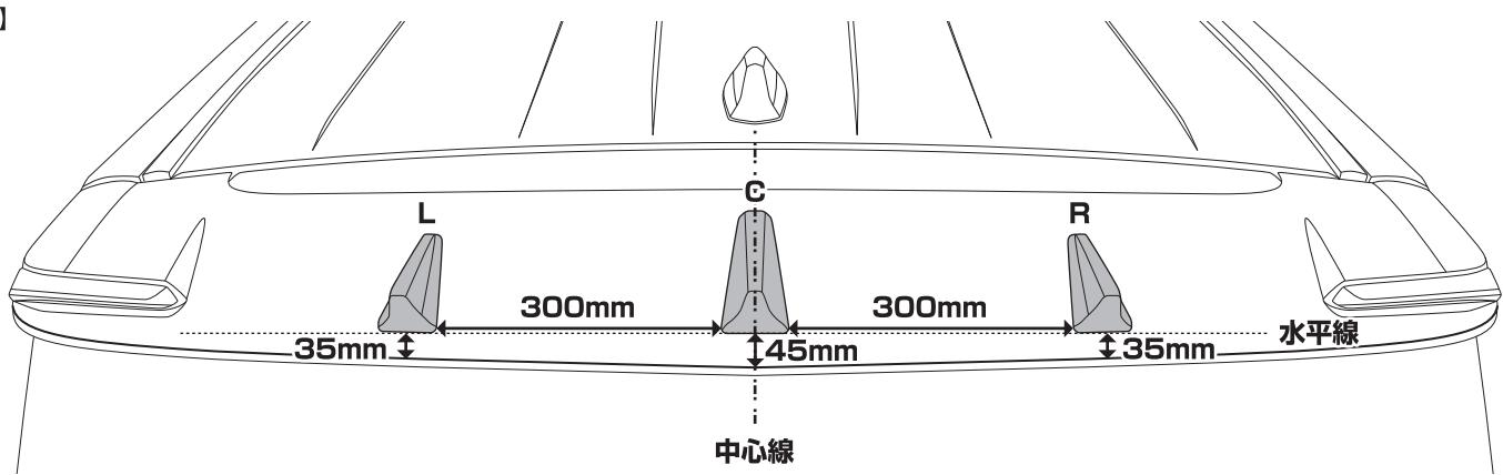
③R/Sを仮付けし、取付位置を確認したのち、取付位置をマスキングテープ等を利用して、マーキングして下さい。この際取付け位置は図2を参照に、純正リヤウイングの中心線をとり、純正リヤウイングの後端から中央で45mm左右で35mmの位置で水平線をとります。この位置を目安に、R/S各部のパーツを合わせて取付位置が決まったら、マスキングテープ等を利用して製品の取付位置をマーキングして下さい。【図2参照】
