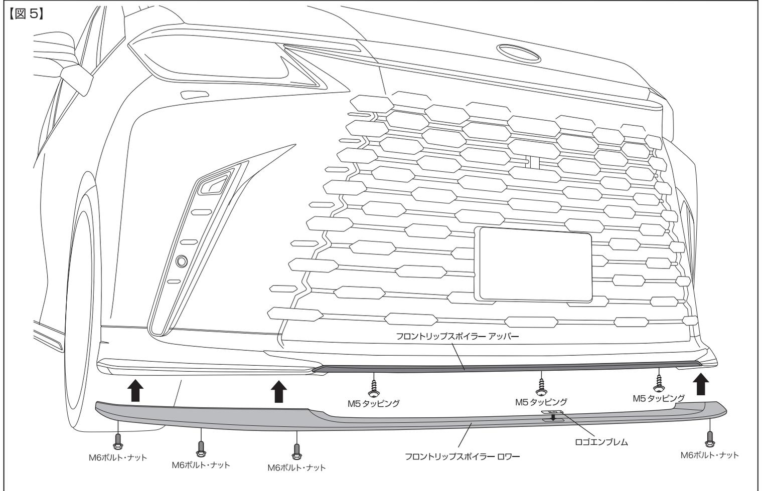
⑦先にF/L アッパーをマーキング位置にしっかりと合わせ、③にて開けた取付穴を利用して付属のM5 タッピングビスにて締込みながらF/L アッパーを取付けます。次にF/L ロワーをマーキング位置にしっかりと合わせ、③にて開けた取付穴を利用して付属のM6 ボルトナットにてF/L ロワーを取付けます。【図5 参照】
