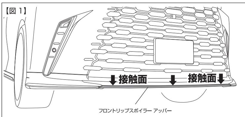
②F/L アッパーを仮付けし、取付位置を確認したら、取付位置をバンパーにマスキングテープ等を利用して、マーキングします。この際、取付位置は、バンパー中央の凹み部分に下から合わせF/L アッパーとバンパーとの接触面がしっかりと合う部分にして下さい。【図1参照】
