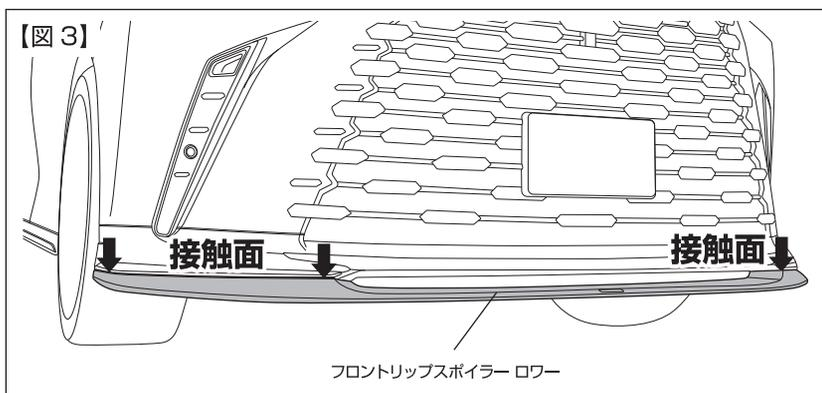
④F/L ロワーを仮付けし、取付位置を確認したら、取付位置をバンパーにマスキングテープ等を利用して、マーキングします。この際、取付位置は、F/L ロワーを下から合わせ、バンパーとの接触面がしっかりと合う部分にして下さい。【図3参照】
