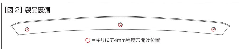
③取付用の穴位置を、バンパーにマーキングしてキリにて穴開けします。初めに、F/L アッパーを取付位置にしっかりと合わせ、穴位置をサービスホールからバンパーにマーキングしたら一度F/L アッパーを外して、バンパーに穴開けを行います。図2を参照にM5 タッピングビス位置（3箇所）はキリで穴開けを行います。【図2参照】
