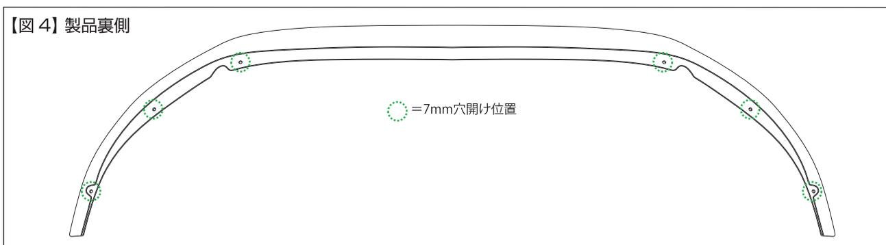
⑤取付用の穴位置を、バンパーにマーキングしてドリルにて穴開けします。初めに、F/L ロワーを取付位置にしっかりと合わせ、穴位置をバンパーにマーキングしたら一度F/L ロワーを外して、バンパーに穴開けを行います。図4を参照にドリルにて7mmの穴開けを行います。【図4参照】
