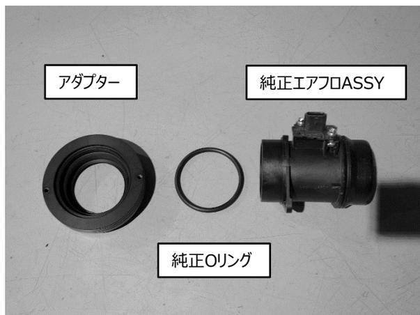
2) 左右のエアフロASSYにアダプターをボルトM6x15とボルトM6x20を使用して仮組します。
