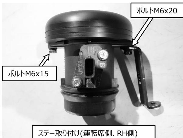
3) 運転席側(RH側)及び助手席側(LH側)のステアの位置及び角度は図を参考に調整して仮組します。
