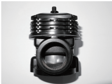
アイドル時ピストンが閉じている状態 (正常)
