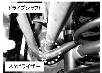
車両に取り付け後、レバライザーリンクロッドが伸びきっていたり、突っ張っていないか確認をしてください。商品によって干渉を防ぐために、レバライザーリンクロッドの取り付け位置を調整するステーやロッドを同梱しているのと同梱されている商品は必ず交換してください。
