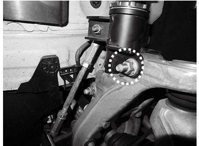
ダンパフォーク取り付けボルト・ナット(上部) 1カ所締め付け 締め付けトルク: 64\text{N}\cdot\text{m} ( 6.5\text{kgf}\cdot\text{m} )
