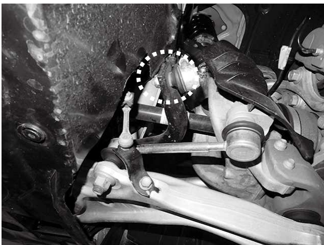
スタビリンク固定ナット(スタビライザー側) 1カ所締め付け 締め付けトルク: 35\text{N}\cdot\text{m} ( 3.6\text{kgf}\cdot\text{m} ) ※キット付属のスタビリンクを使用してください ※調整式スタビリンクになっているので長さ・傾きを合わせて ナットを締め付け固定してください 締め付けトルク: 60\text{N}\cdot\text{m} ( 6.1\text{kgf}\cdot\text{m} )
