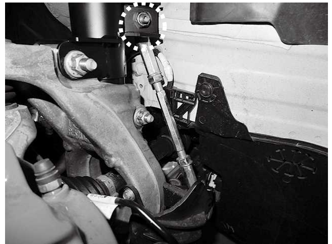
スタビリンク固定ナット(ショック側) 1カ所締め付け 締め付けトルク: 64\text{N}\cdot\text{m} ( 6.5\text{kgf}\cdot\text{m} ) ※キット付属のスタビリンクを使用してください ※調整式スタビリンクになっているので長さ・傾きを合わせて ナットを締め付け固定してください 締め付けトルク: 60\text{N}\cdot\text{m} ( 6.1\text{kgf}\cdot\text{m} )
