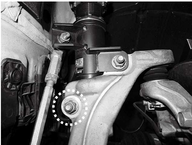
ダンパフォーク取り付けボルト・ナット(下部) 1カ所締め付け 締め付けトルク: 64\text{N}\cdot\text{m} ( 6.5\text{kgf}\cdot\text{m} )
