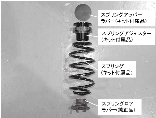
上写真を参照し、車両に取り付けてください ※スプリングロアラバーは 取り付け前に加工が必要になります
