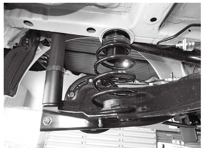
スプリング取り付け状態 ※スプリングアッパーラバー、ロアラバーが きっちりハマっているか確認してください
