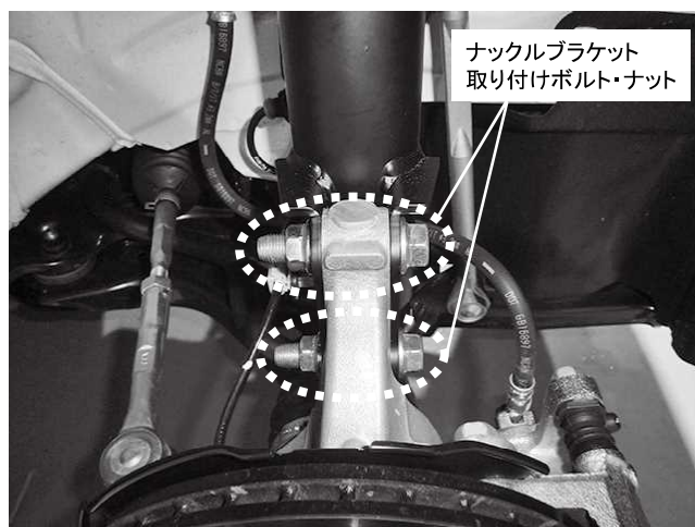
ナックルブラケット取り付けボルト・ナット 2カ所締め付け 締め付けトルク: 65N・m(6.6kgf・m) ※取り付け上部は長穴になっておりキャンバー調整が可能です
