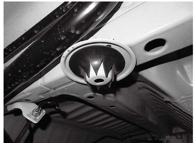
スプリングアッパーラバー取り付け状態 ※スプリングアッパーラバーが きっちりハマっているか確認してください
