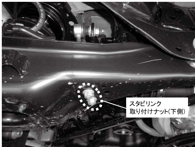
スタビリンク取り付けナット(下側) 2カ所締め付け 締め付けトルク: 50N・m(5.1kgf・m)
