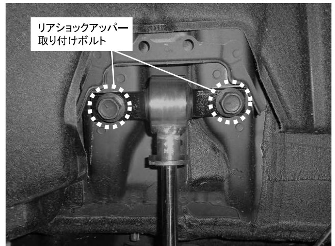
リアショックアッパー取り付けボルト 2カ所締め付け 締め付けトルク: 90N・m(9.2kgf・m)
