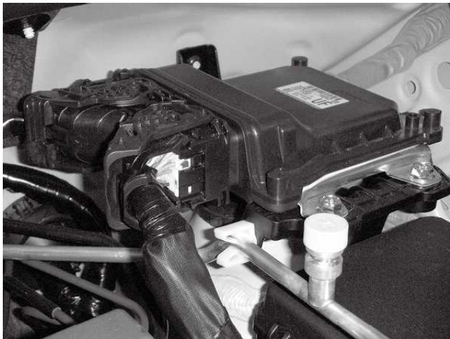
左側(助手席側)には上部にECUがあるため、作業時はECUをずらして作業を行ってください ※この時ハーネスに負担がかからないようにしてください また、ずらした際にコネクタが抜けないように注意してください
