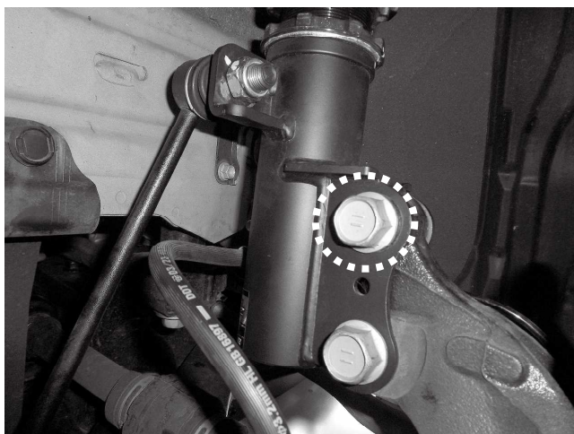
ショックアブソーバーナックルブラケット上側取り付け穴は 長穴になっており、キャンバー調整が可能です 左右で位置を合わせて取り付けてください
