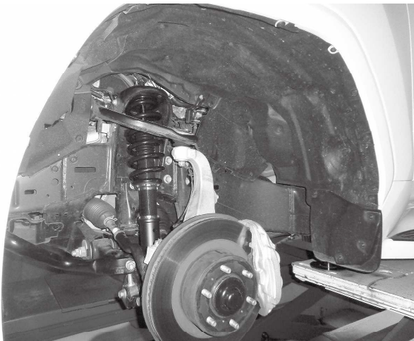
フロント左側(助手席側)取り付け状態
