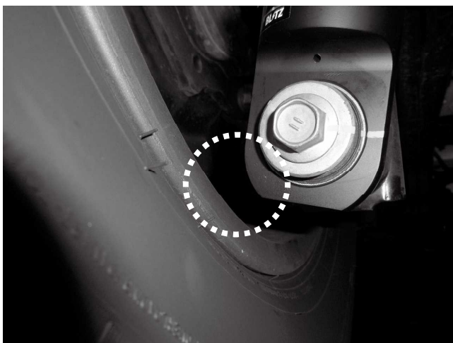
リアショックロアブラケットと タイヤ・ホイールとのクリアランスを 確認してください
