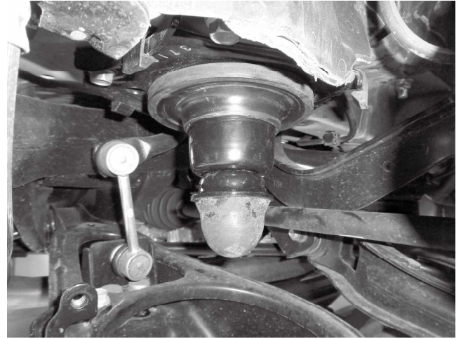
リアスプリング取り付け前に キット同梱のショートバンブラバーを取り付けてください ※取り付け方法は別紙のバンブラバー取り付け説明書 を参照してください
