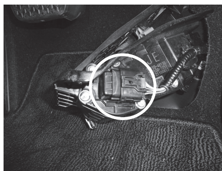
ペダル下のユニット横にセンサーとコネクターがあります。
