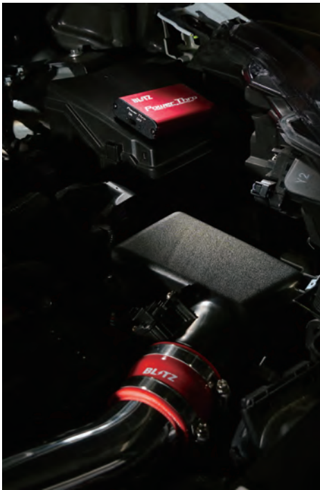
NA車やハイブリッドのエアフロセンサーを制御することで、安全かつ確実にパワーアップを実現。新型GR86/BRZ(MT車)では約13.8psアップするなど、その効果は侮れない!
