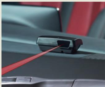
TL311Sはレーザー受信部と本体が別体のため、よりレーザーを受信しやすい位置を選んで設置することが可能。受信センサーは超高感度センサーを使用する。
