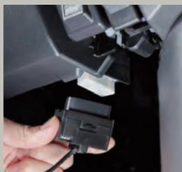
これまでタッチブレインで培った技術に応用し、車両情報を手軽に表示できる機能をオプションとして導入。スピードやエンジン回転数、ハイブリッド車ならバッテリー残量など様々な情報を表示できるため、追加メーターとしても活用できるのは最大のトピック。
