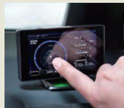
新たに投入されたTL401RとTL311Sでは静電式タッチパネルを採用するためフリック操作も可能。このタッチパネルの差異がエントリー機種との違いのひとつ。
