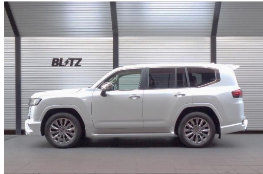
フロント：20mmダウン / リア：30mmダウン
