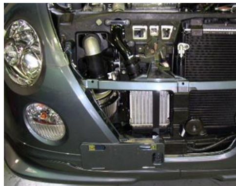
ダイハツ コペン L880K用 SUS POWER 装着写真 ※写真はシラウドプレートを外しています
