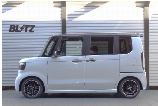
フロント：23mmダウン / リア：30mmダウン
