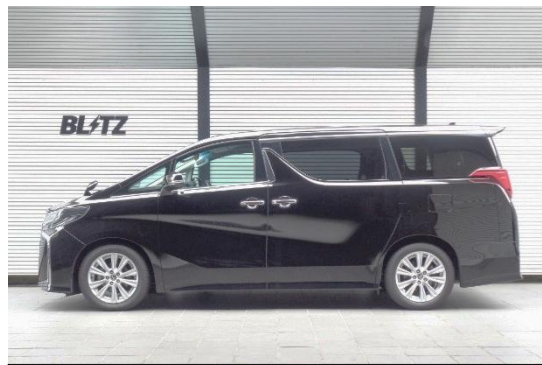
フロント：28mmダウン / リア：34mmダウン
